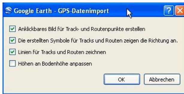
Die Flugbahn wird nun nach kurzer Ladezeit in Google Earth dargestellt. Die geladene GPX-Datei ist unter **Temporäre Orte** als **GPX device** in der Orte-Liste zu finden. Durch Öffnen der Unterverzeichnisse gelangt man zu den einzelnen Track-Punkten. Die Track-Punkte können angewählt und mit allen Daten wie im Beispiel angezeigt werden.
