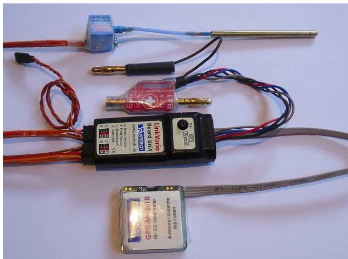
LinkVario Board Unit mit Pitot-Speed-Sensor, Temperatursensor, GPS und Stromsensor.
