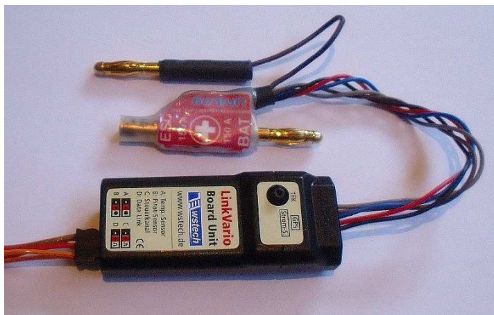
LinkVario Board Unit mit Stromsensor zur E-Antriebsüberwachung (Strom, Spannung und Kapazität)
