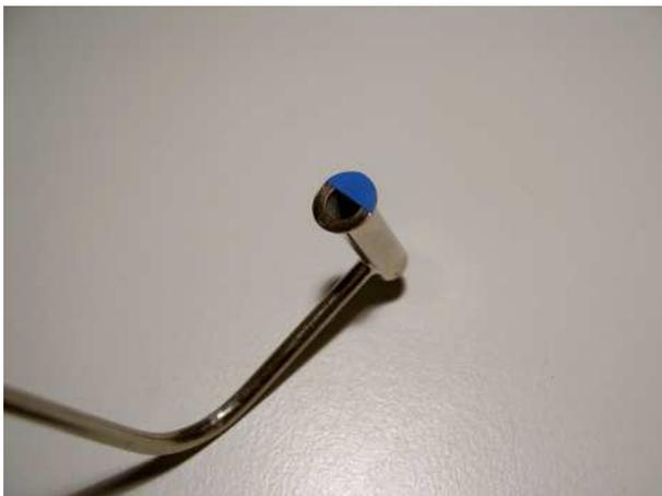
Wenn die Kompensation verringert werden soll, kleben sie einen Tesafilm so auf die Endscheibe der Düse, dass ein Teil der Austrittsöffnung abgedeckt wird. Je mehr verschlossen wird, desto geringer wird die Kompensation. Schneiden sie den Tesa sauber ab, so dass außen nichts übersteht (siehe Foto).
