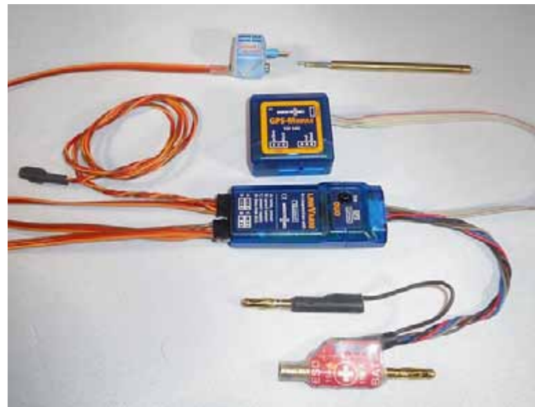
LinkVario mit Pitot-Speed-Sensor (oben), Temperatursensor, GPS und Stromsensor (unten)
