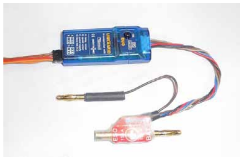
LinkVario mit Stromsensor zur E-Antriebsüberwachung (Strom, Spannung und Kapazität)
